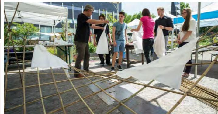
Das Konstruktionsprinzip des Hallendaches wurde im ersten Teil der Modellwerkstatt analysiert. Hierzu bauten die Studierenden unter Leitung des Bauingenieurs André Zaman zunächst eine Konstruktion aus parallel verlaufenden Bambusstäben.
