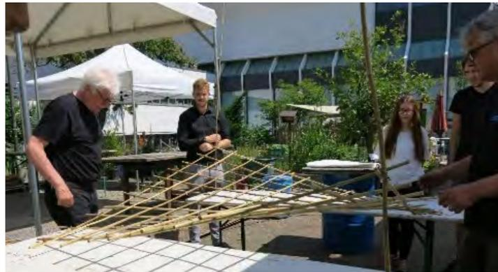
Die an den Seiten befestigten Stäbe sowie ein Zugband ermöglichten die Verformung der flachen Konstruktion in die Dreidimensionalität.
