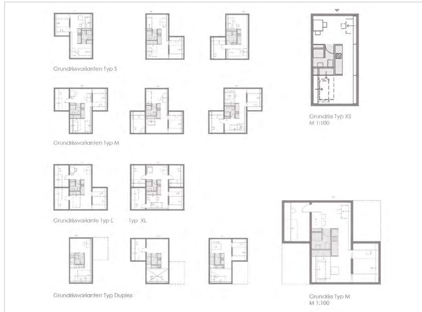
Durch die Kombination der installierten Box und der Raummodule sind variable Grundrissformen möglich, wobei die Box immer das Zentrum der Wohnung bildet und für die vertikale Erschließung immer an der gleichen Stelle liegt.
