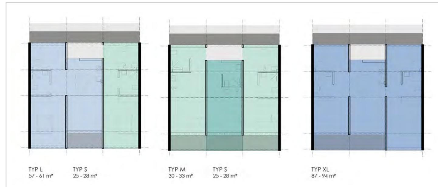
Festgelegte Bereiche: Laubengangzone (dunkelgrau) und Verkehrsflächen (hellgrau). Die grau unterlegten Farbflächen zeigen den Balkon, der durch ein Zurücksetzen der Außenwand entsteht.
