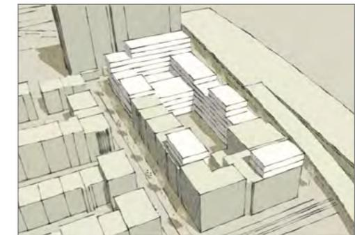
Veränderte Blockstruktur nach Rückbau, Neubau und Aufstockungen.
