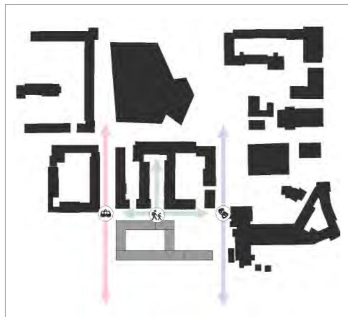
Lärmschutz durch überhöhten Blockrand im Süden.
