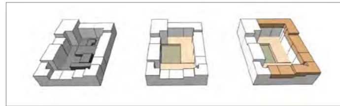
Aufstockung der Gebäude und Terrassierung des Innenhofs.
