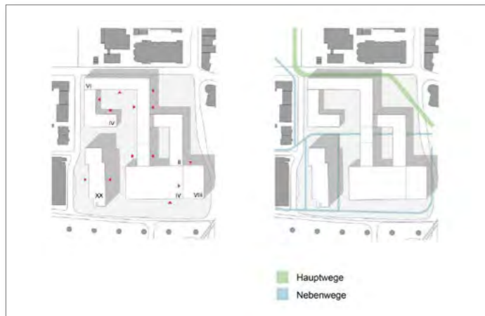
Wegeführung durch den Block mit einer Querverbindung zwischen Berliner Platz und Block 3 (rechts), Geschossigkeit der verschiedenen Gebäude (links).
